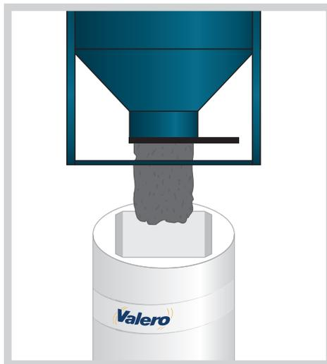
Para encofrados con junta de dilatación: El vertido del hormigón se realizará de forma simultánea en ambos lados del encofrado para evitar sobrepresiones en un lado u otro.
