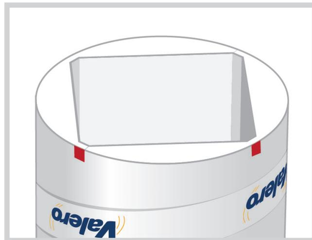
A la hora de replantar el pilar, se marcará la sección cuadrada en el forjado. Después se marcan las proyecciones de las caras del pilar en el encofrado y se hacen coincidir con las marcas del forjado.
