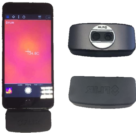
Fig. 2: Cámara termográfica utilizada
